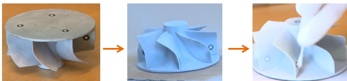
Obr. 5: Postup přípravy součásti před optickým skenováním
