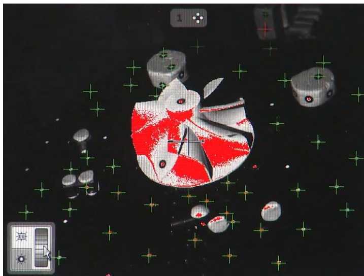
Obr. 6: Nastavení expozičního času v SW GOM Atos Professional
